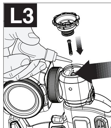
• Con el aceite lubricante provisto, aplique unas pocas gotas de aceite por las aberturas de entrada y retorno del pulverizador como se muestra en la **Figura L4**.
